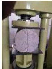
Fig 4.4 Spilt tensile strength
