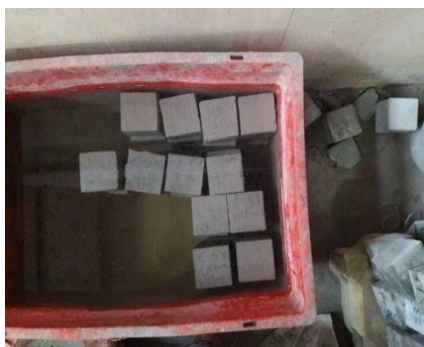
Fig no: 3 Curing of CSC mortar cubes
