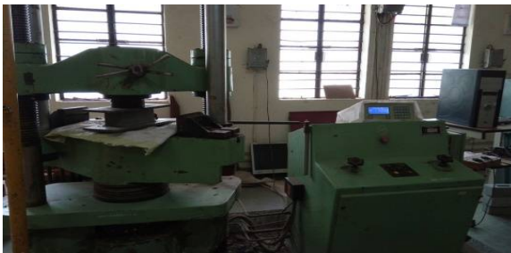
(d) Universal Testing Machine with brick Specimen
