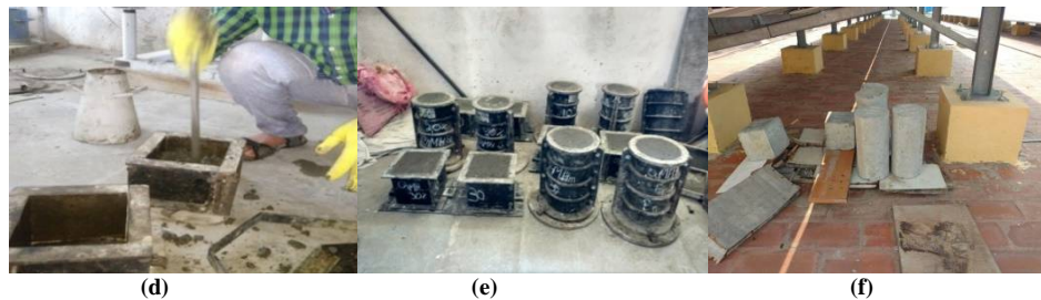
Fig.4 (d) Compacting (e) Moulding (f) Ambient curing
