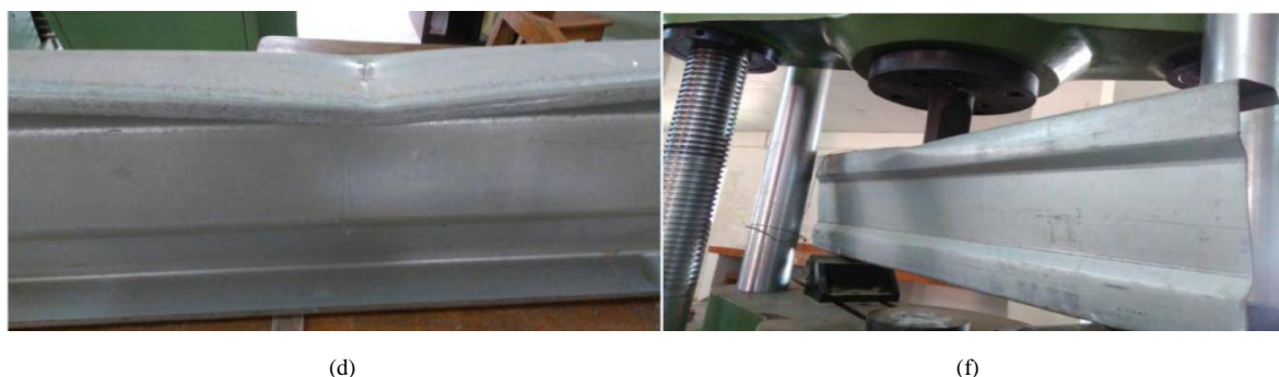
Fig. 3 (d) Distortional buckling (f) Web buckling
