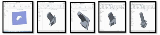
Fig 3aFig3bFig 3cFig 3dFig 3eFig 3 (a) 2D MODEL OF GAS TURBINE BLADEFig 3 (b) WITHOUT HOLES GAS TURBINE MODEL Fig: 3<br/>(c) WITH 4 HOLES (CONVECTION COOLING) GAS TURBINE MODELFig: 3 (d) WITH 6 HOLES<br/>(CONVECTION COOLING) GAS TURBINEMODEL3.2 (e) WITH HOLES (FILM COOLING) GAS<br/>TURBINE MODEL
