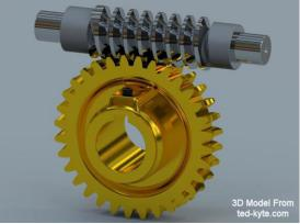
Fig1 : Worm Gearing
