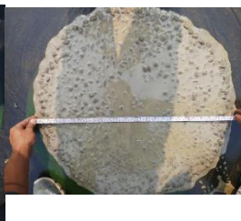
Fig: 4 Slump Flow
