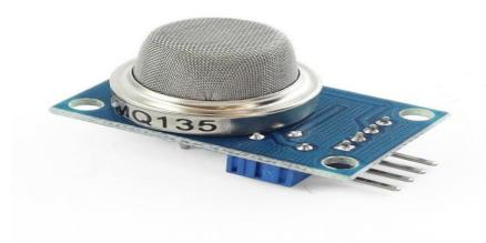
Fig.4.MQ135 Gas Sensor
