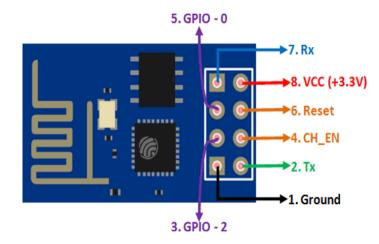
Fig.7.16\*2 ESP8266 Wi-Fi Module
