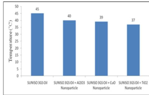
**FIG.8. TEMPERATURE OF REFRIGERANT AT THE OUTLET OF THE CONDENSER**
