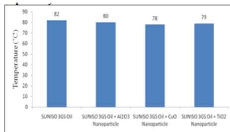
**FIG.7. TEMPERATURE OF REFRIGERANT AT THE INLET OF THE CONDENSER**
