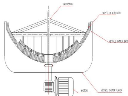
Fig 4 (d) Paddle Agitator Assembly
