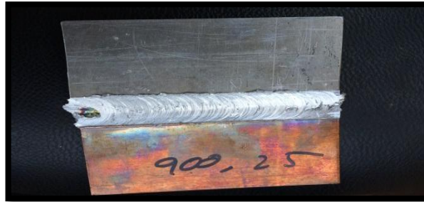
Fig. 3: Welded Al & Cu plate
