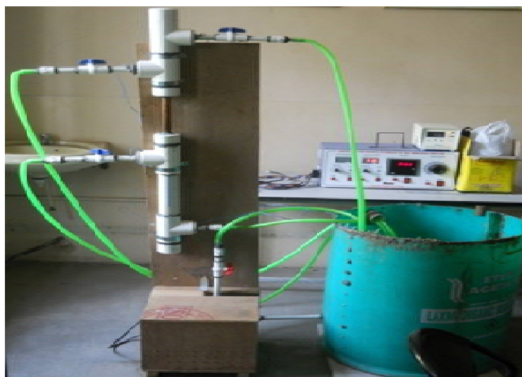
Fig.-1 Actual wickless heat pipe test rig image.
