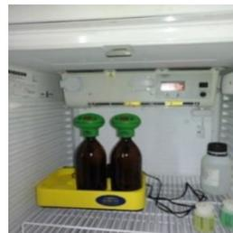
**Photo 2 :** Introduction de l'oxitop dans l'armoire thermostatique
