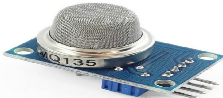
Fig.4. MQ135 Gas Sensor
