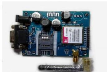
Fig.e GSM Module
