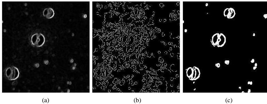
Fig.3 Edge Detection (a) Edge detection using morphology (b) Edge detection using canny algorithm (c) Edge Map.
