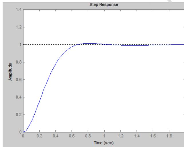
Figure (5) close – loop step  $k_p=30$   $k_i = 70$
