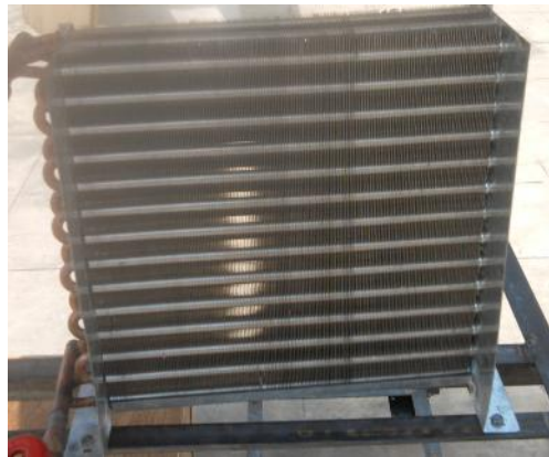
Fig. 5 Actual photo of Condenser
