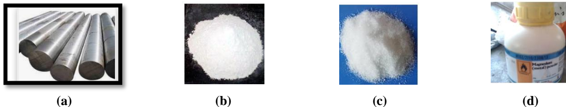
Fig2.1: shows a) Aluminum alloy Al6061 b) K_2TiF_6 c) KBF_4 d) magnesium
