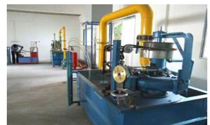
Fig: 3 Kaplan Turbine Apparatus
