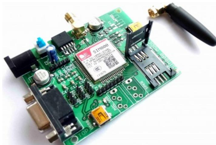
Fig : GSM SIM900A
