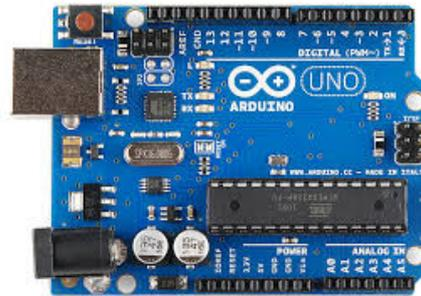
Fig : Arduino Uno(ATmega328p)
