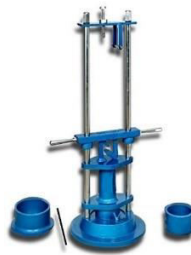
Fig. 1 Impact Value Test Apparatus
