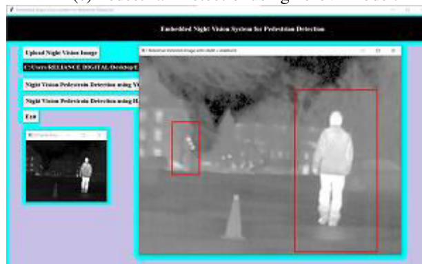
(d) Pedestrian Detection using HaarHog Descriptor with adaboost
