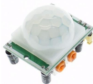
Fig. 6. PIR sensor (HC-SR501)
